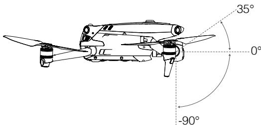
通过遥控器的云台俯仰控制拨轮和 DJI Pilot 2 App 可调整俯仰角度。在 DJI Pilot 2 App 相机界面长按屏幕直至出现蓝色光环，通过上、下拖曳光环可调整云台俯仰角度。
