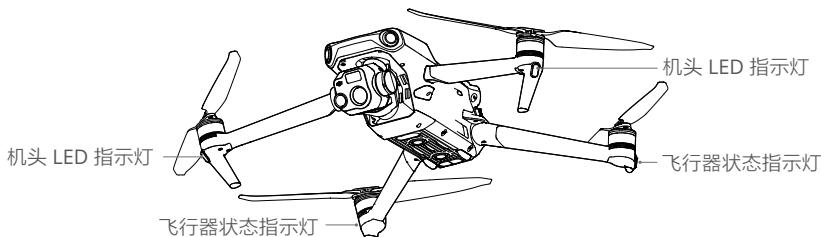
机头 LED 指示灯用于指示飞行器的机头方向，飞行器开启且电机未启动时将显示红灯常亮。
