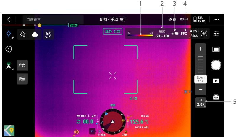
1. 调色盘：显示当前画面测温最高值和最低值，点击后可以选择不同的红外测温调色盘；也可打开等温线功能，设置测温区间（需注意，测温区域若超过当前画面测温的最高值或最低值，将不会生效）。
