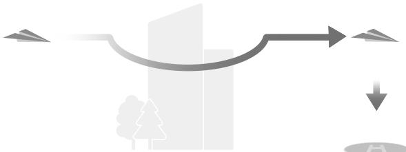
2. 智能高度：飞行器将根据环境（障碍物、图传信号等）智能地调整飞行高度，用户设定的返航高度此时不生效。此最佳返航路径较短，可以节省电量，增加飞行时间。
