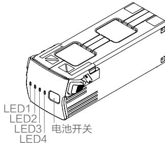
电量指示灯可用于显示智能飞行电池充放电过程中的电量，指示灯定义如下。
