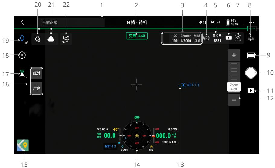
1. 顶部状态栏：顶部状态栏将显示飞行器状态、挡位、信号质量等信息。详细内容请阅读顶部状态栏章节。
